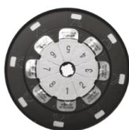
*Permette l'analisi anche in contemporanea di 8 campioni biologici, attraverso il semplice inserimento del campione biologico e dei reagenti di amplificazione negli appositi spazi del disco, permettendo così di effettuare i 3 passaggi necessari per eseguire test PCR (estrazione, amplificazione e identificazione) in un unico passaggio. Il sistema è quindi estremamente semplice e veloce da utilizzare. Soddisfa la necessità di risultati rapidi e “on demand”.*
