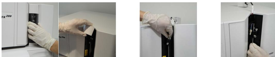
図 3-6 シールドとライトカバーを取り外し(左)、フィッティングを回し(中央)、プローブを抜き取る(右)
