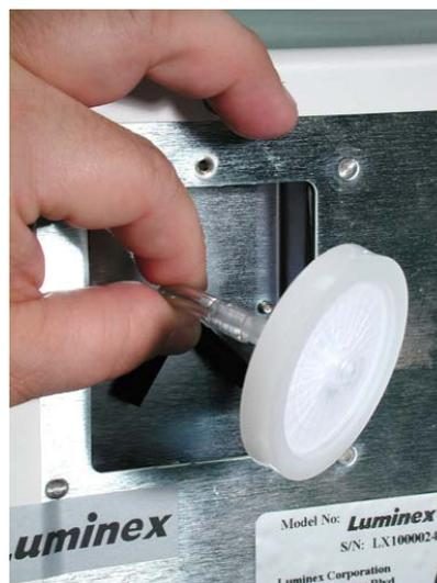
図 3-10 リアエアフィルター(左)とリアエアフィルターの取り外し方(右)
