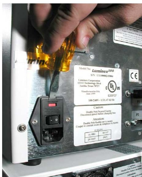
図 3-20 モジュールドアの開け方
