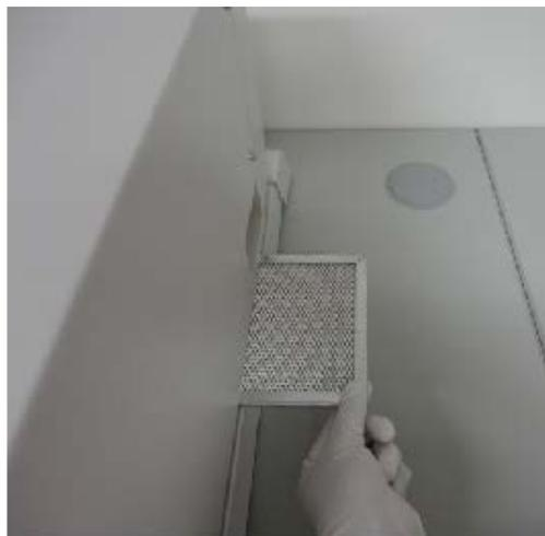
図 3-16 ボトムエアフィルターの取り外し: アナライザの右側から押し出し、左側から引き抜く
