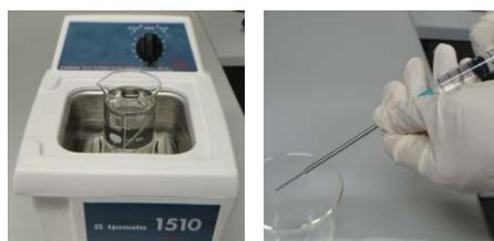
図 3-7 プローブの超音波洗浄(左)、注射器を用いた確認(右)
