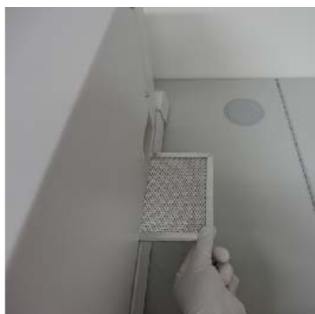
図 3-12 ボトムエアフィルターの取り外し: アナライザの右側から押し出し、左側から引き抜く
