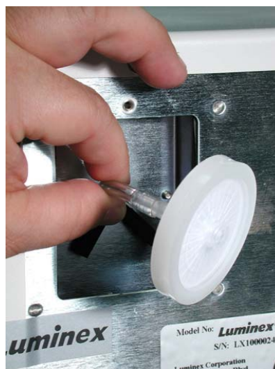
図 3-6 リアエアフィルター(左)とリアエアフィルターの取り外し方(右)
