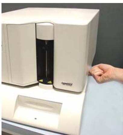
図 3-12 ボトムエアフィルターの取り外し: アナライザの右側から押し出し、左側から引き抜く
