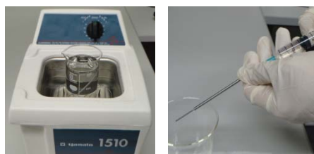
図 3-4 プローブの超音波洗浄(左)、注射器を用いた確認(右)
