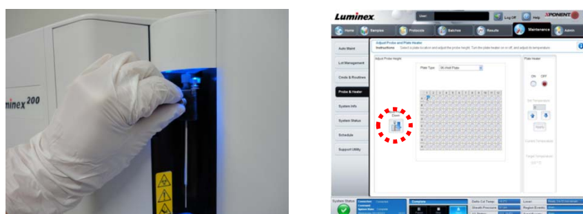
図 3-2 プローブの固定(左)、xPONENT3.1 からのプローブ操作画面(右)
