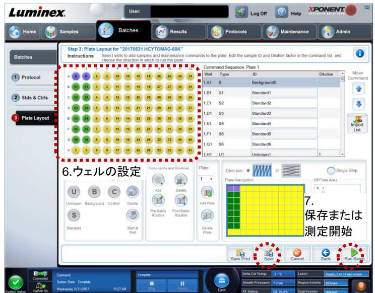
6. 測定を行う場合には、Run Batch をクリックします。後で測定を行う場合には、Save をクリックすると Pending Batch リストに Batch が保存されます。測定が始まると、自動的に Results ページの Current Batch タブに移り、結果が表示されます。
