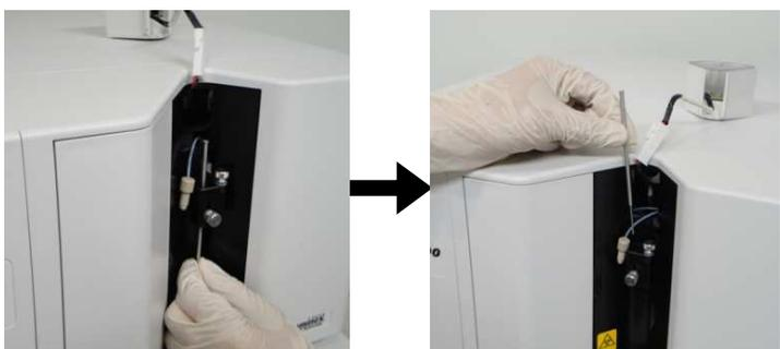
6. プローブを蒸留水の入ったビーカーに入れ、超音波洗浄器で約5分洗浄します。その後、注射器でつまりがないことを確認します。プローブの太い方から行い、その後、細い方からも確認します。
