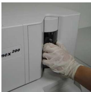
10. アナライザ本体の電源ケーブルを差し込み、電源を入れ、xPONENT 4.2 ソフトウェアからプローブ高さ調整 (P7)を行います。
