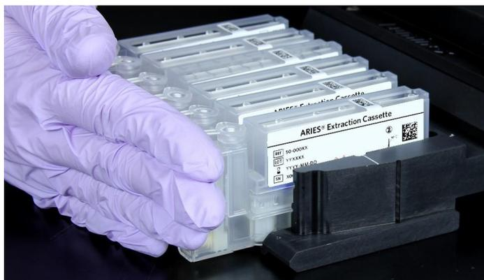
12. Setzen Sie das Magazin in das ARIES-System ein. Informationen zur Überwachung des Status eines Laufs finden Sie unter „Den Lauf überwachen“ auf Seite 8.
