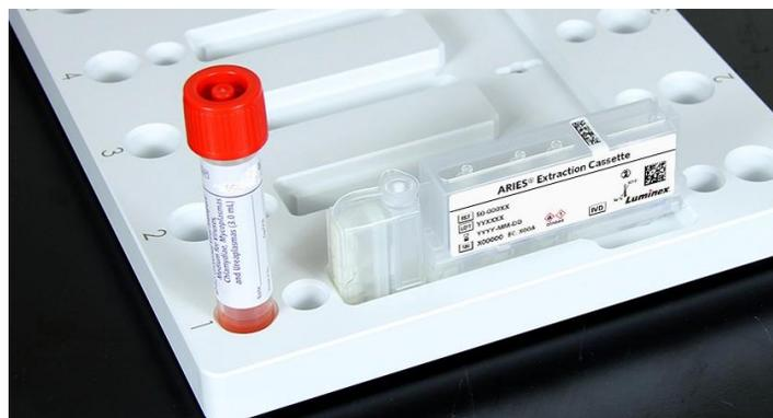
4. Schütteln Sie die Probe für 5 bis 10 Sekunden, um sie zu homogenisieren.
