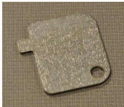
2. Insérez l'outil dans le loquet de la porte d'accès latérale et tournez-le d'un quart de tour dans le sens des aiguilles d'une montre. Faites glisser la porte vers la droite.
