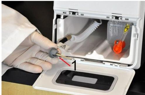
5. Insérez une partie du flacon de liquide de gaine dans l'ouverture du compartiment à liquide et retirez l'opercule.
