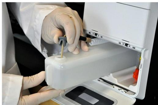
7. Faites glisser le flacon dans le plateau sur le côté gauche du compartiment à liquide. Le plateau est conçu pour maintenir le flacon en place.
