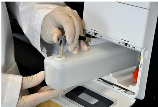
7. Deslice el frasco en la bandeja de la parte izquierda del compartimento de líquidos. La bandeja está fabricada para sujetar el frasco.
