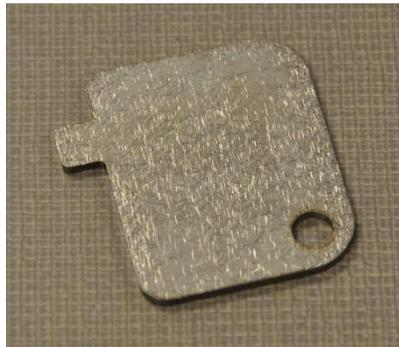
2. Inserte la herramienta en el pestillo de la puerta de acceso lateral y gírela un cuarto de vuelta en el sentido de las agujas del reloj. Deslice la puerta hacia la derecha.
