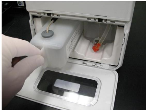
8. Cuando el frasco se haya introducido completamente, compruebe la válvula de la parte delantera del frasco de líquidos desechados para asegurarse de que está sujeto con seguridad y cierre la puerta del compartimento de líquidos.
