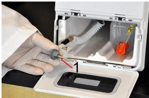
5. Inserire parzialmente il flacone del liquido di trascinamento nell'apertura del vano liquidi e rimuovere la guarnizione.
