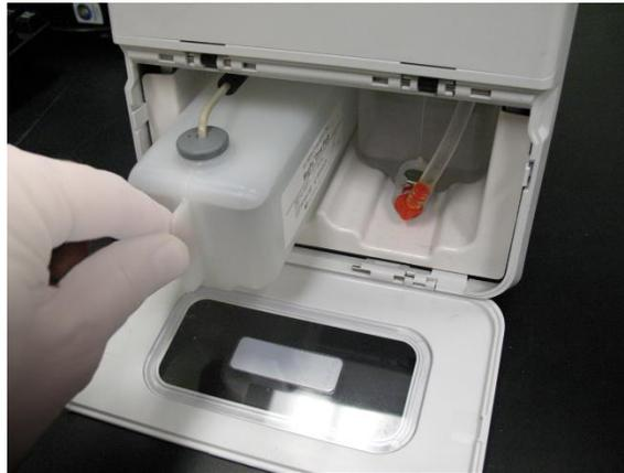
9. Dopo aver inserito completamente il flacone, controllare la valvola sulla parte frontale del flacone del liquido di scarto per assicurarsi che sia saldamente fissato, quindi chiudere lo sportello del vano liquidi.
