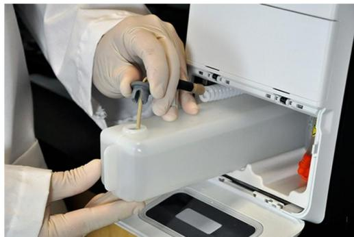
8. Spingere il serbatoio all'interno dello scomparto che si trova a sinistra del vano liquidi. Lo scomparto è stato progettato per mantenere in posizione il serbatoio.
