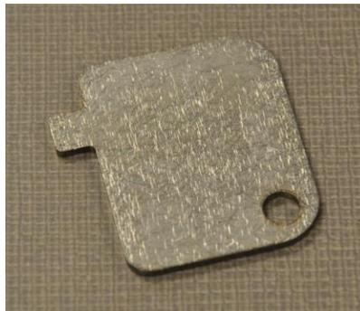
2. Stecken Sie das Werkzeug in die Verriegelung der seitlichen Zugangstür und drehen Sie es eine Vierteldrehung im Uhrzeigersinn. Schieben Sie die Tür nach rechts.
