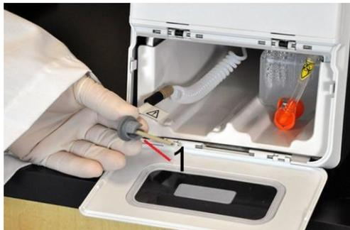
5. Schieben Sie die Antriebsflüssigkeitsflasche bis zur Hälfte in das Flüssigkeitsfach und entfernen Sie die Versiegelung.
