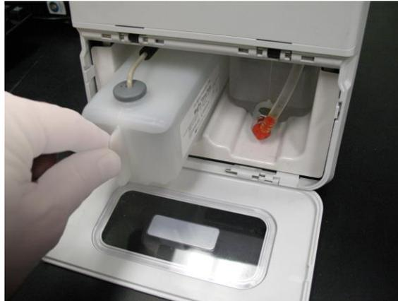
8. Nachdem Sie die Flasche vollständig eingeschoben haben, prüfen Sie das Ventil an der Vorderseite der Abfallflüssigkeitsflasche, um sicherzustellen, dass sie sicher befestigt ist, und schließen Sie dann die Tür des Flüssigkeitsfachs.
