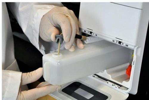
7. Schieben Sie die Flasche in die Ablage links im Flüssigkeitsfach. Die Ablage ist so geformt, dass die Flasche nicht verrutscht.
