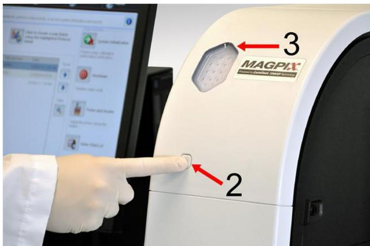
**REMARQUE** : l'interrupteur d'alimentation électronique permet d'activer et de désactiver l'appareil.
