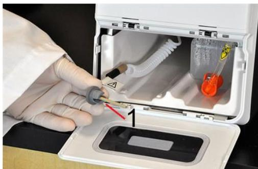
5. Insérez le récipient de liquide de gaine à mi-distance dans le logement du compartiment de liquide et retirez l'opercule.
