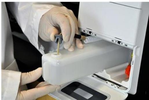
7. Faites glisser le récipient sur le plateau, dans la partie gauche du compartiment de liquide. La forme du plateau lui permet de maintenir le récipient en place.
