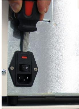
4. Prüfen Sie beide Sicherungen im Steckmodul auf Schäden. Eine Sicherung kann eine materielle Beschädigung aufweisen, z.B. einen gebrochenen Draht oder geschwärztes Glas. Falls an der Sicherung keine materielle Beschädigung erkennbar ist, führen Sie mit einem Voltmeter eine Durchgangsprüfung durch.
