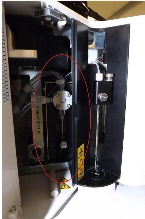
3. Lockern Sie unten an der Spritze die Rändelschraube (sechs Vierteldrehungen gegen den Uhrzeigersinn).
