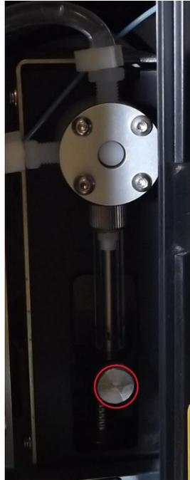
8. Ziehen Sie den Kolben aus der Spritze heraus.
