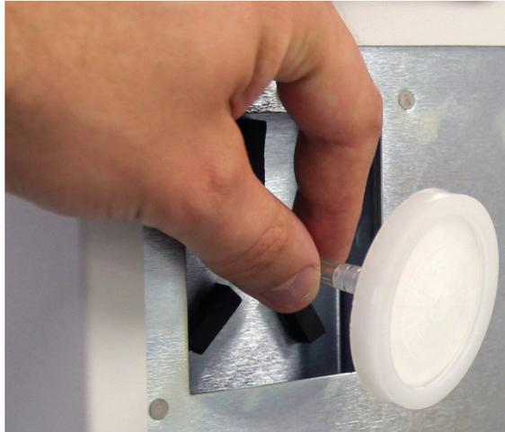
4. Entfernen Sie den Luminex 200- Lufteinlassfilter mit einer Hand, während Sie den Schlauch mit der anderen Hand festhalten.
