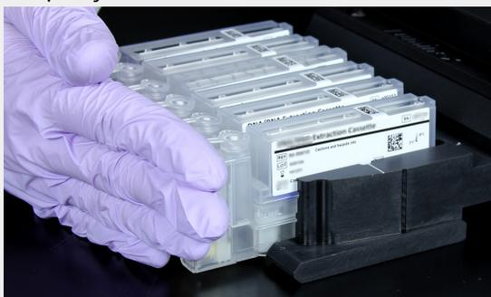
1. Após adicionar a amostra ao cassete e fechar bem a tampa, alinhe o cassete com a fenda localizada no carregador (uma aba do cassete se encaixa na fenda). O tubo de RCP deve ficar voltado para os números do carregador.
