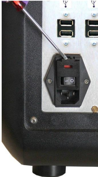
3. Verwenden Sie den Schraubendreher, um das rote Steckmodul zu entfernen.
