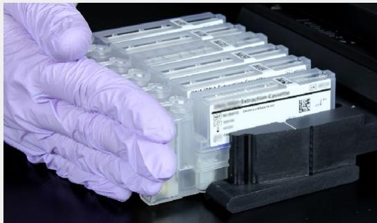
1. Nachdem die Probe in die Kassette übertragen und der Deckel fest verschlossen wurde, richten Sie die Kassette nach der Kerbe auf dem Magazin aus (es gibt am Ende der Kassette eine Sicherung, die genau in diese Kerbe passt). Das PCR-Röhrchen muss in Richtung der Ziffern auf dem Magazin zeigen.
