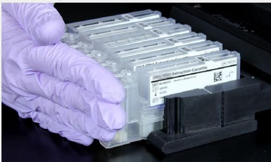
1. Depois de a amostra ter sido adicionada à cassette e a tampa ter sido firmemente fechada, alinhe a cassette com o entalhe existente no carregador (a extremidade da cassette dispõe de uma saliência que encaixa no entalhe). O tubo de PCR tem de ficar virado no sentido dos números gravados no carregador.
