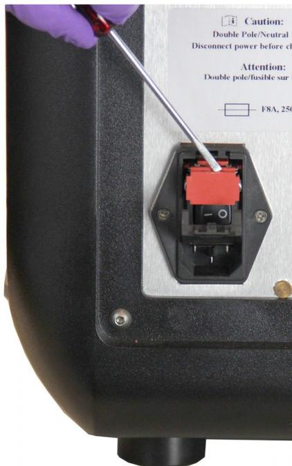
4. Verificare lo stato dei fusibili nella cartuccia. Un fusibile può presentare danni fisici evidenti, ad esempio un filo spezzato o il vetro annerito. Se il fusibile non presenta danni, testarne la continuità con un voltmetro
