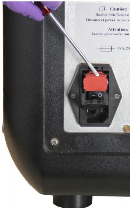
4. Contrôlez l'état des deux fusibles de la cartouche. Un fusible peut présenter des signes visibles de dommage, par exemple une rupture de câble ou un verre noirci. Si le fusible ne présente aucun signe visible, testez la continuité du fusible à l'aide d'un voltmètre.
