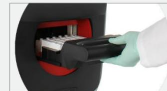
5. El instrumento **ARIES** escanea automáticamente los casetes. **NOTA:** Si está activado Auto Run (Experimento automático), no es necesario continuar con el paso 6.
