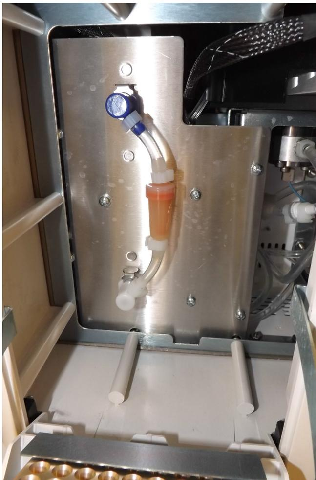
4. Подсоедините новый фильтр проточной жидкости, соблюдая цветовые обозначения креплений. Стрелка на фильтре проточной жидкости должна указывать вверх.
