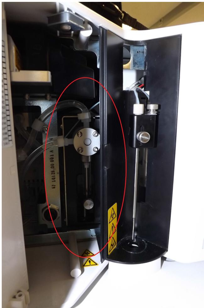
3. В основании шприца ослабьте барашковый винт, повернув его против часовой стрелки на 90 градусов шесть раз.
