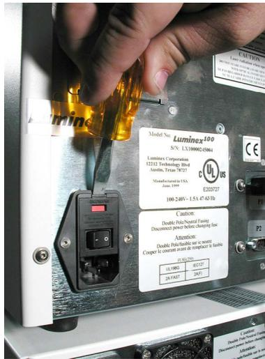
3. Извлеките красный патрон (с помощью плоской отвертки).
