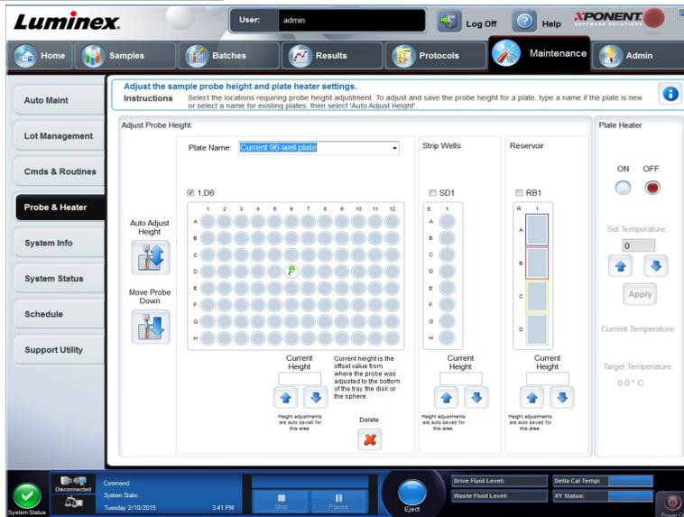
Probe & Heater（探测装置和加热器）标签用于调节探测装置高度和微量滴定盘加热器设置。
