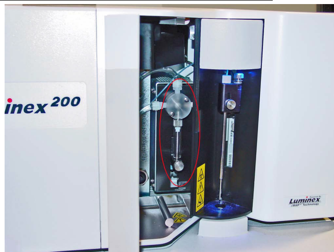
図 9. ドアを開いてシリンジが露出した状態の Luminex システムの正面ビュー
