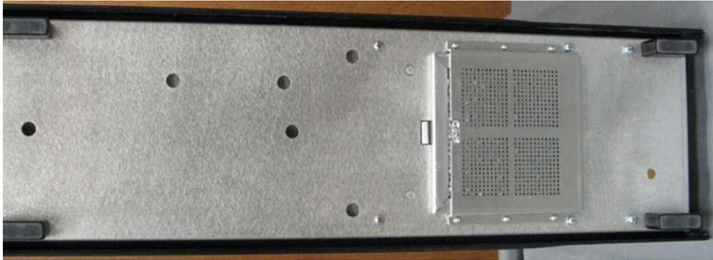
图 49. MAGPIX 后部 · 显示固定架中的过滤器
