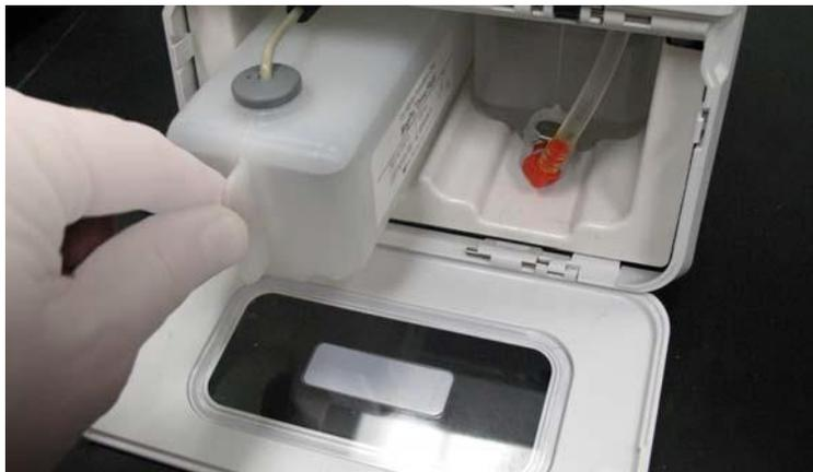
8. 容器完全插入后，检查废液容器确保连接稳定，然后关闭液体仓的门。
