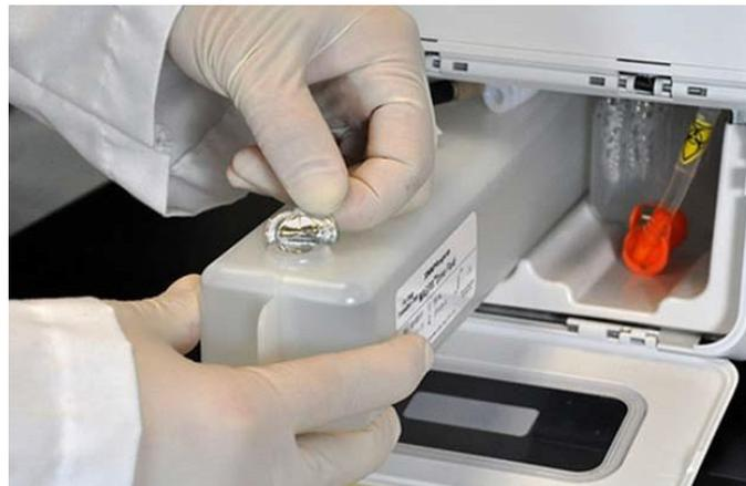
6. 连接驱动液管并插入驱动液容器顶端开口。
