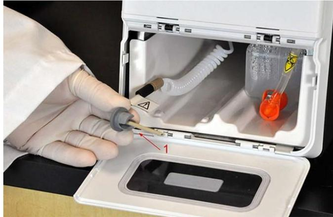
5. 将驱动液容器的一部分插入液体仓并取下密封圈。
