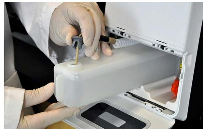
7. 将容器滑入液体仓左侧托盘。容器托盘可将容器固定到位。
