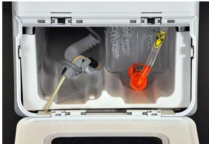
4. 向前拉液体仓左侧的驱动液和塞子 (1) 直到其伸出仓外。将其拉到左侧以插入驱动液容器。
