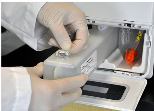
6. Вставьте трубку и пробку рабочей жидкости в отверстие, имеющееся наверху контейнера с рабочей жидкостью.
