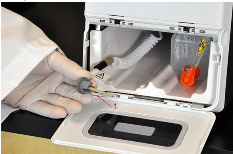
5. Наполовину вставьте контейнер с рабочей жидкостью в проем отделения для жидкостей и снимите пломбу.
