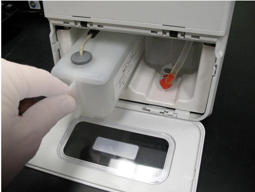
8. После того, как контейнер будет полностью вставлен, проверьте клапан, расположенный на передней части контейнера для отработанной жидкости, чтобы удостовериться, что контейнер надежно подсоединен, после чего закройте дверцу отделения для жидкостей.
