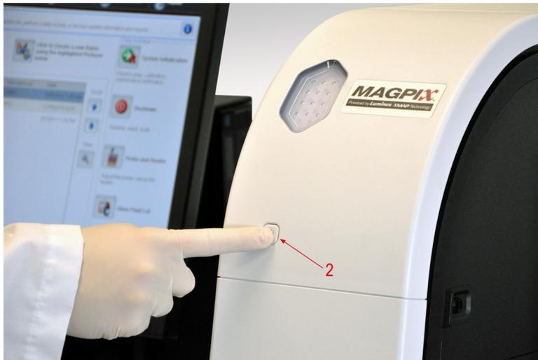
4. После включения прибора MAGPIX выдвиньте каретку лотка с помощью программного обеспечения и установите на место блок для реагентов.
