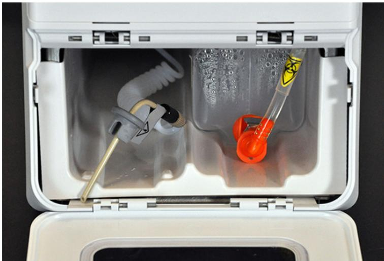
4. Потяните трубку и пробку (1) рабочей жидкости, расположенные с левой стороны отделения для жидкостей, вперед так, чтобы трубка и пробка выдвинулись за пределы отделения. Потяните трубку и пробку влево, чтобы освободить место для установки контейнера с рабочей жидкостью.
