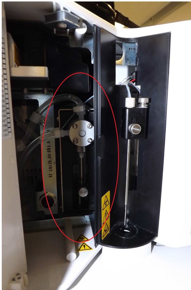
FIGURA 10. Visão frontal de um sistema Luminex® com a porta aberta e a seringa exposta
