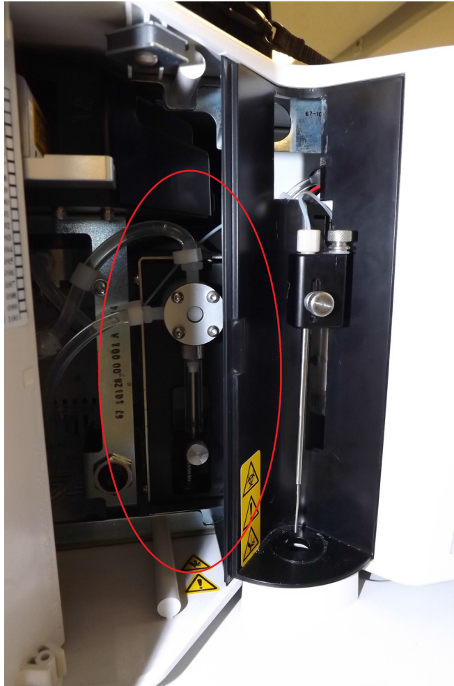
BILD 10. Luminex®-systemet sett framifrån med luckan öppen så att sprutan syns
