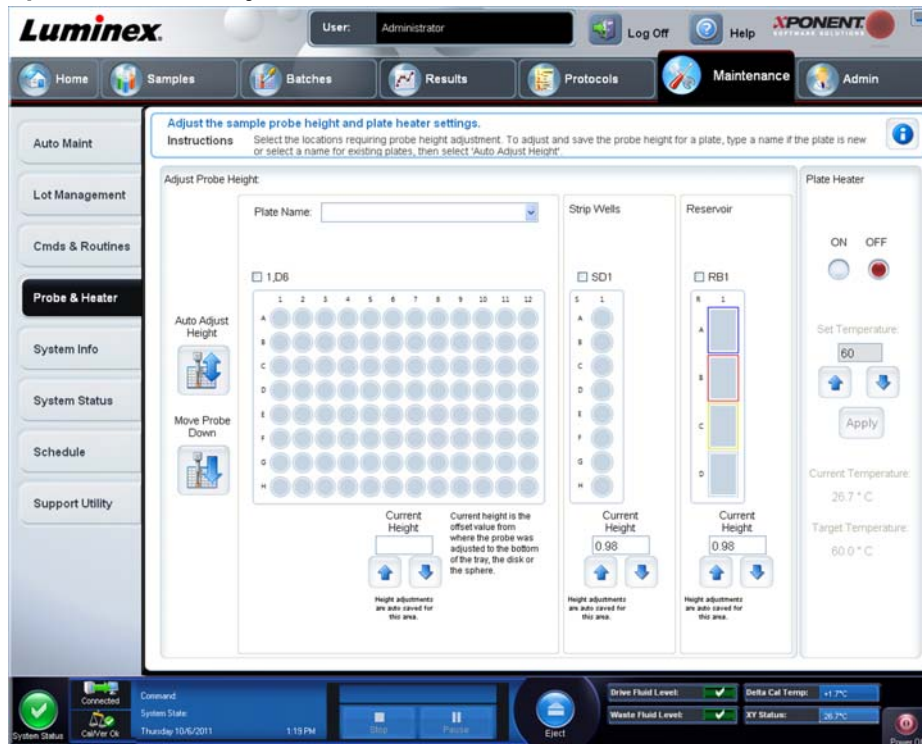
FIGUR 35. Justering af prøvesondens højde
