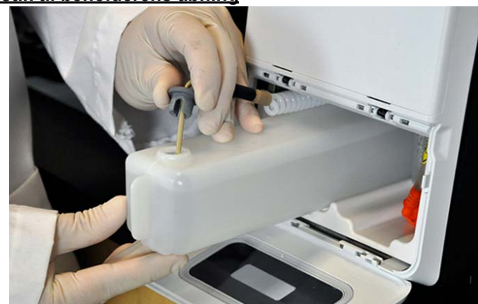
FIGUR 31. Tilslutning af rør og stik til beholderens åbning
