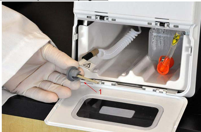
FIGUR 29. Udtrækning af Drive Fluid-rør (drivvæske) og stik
