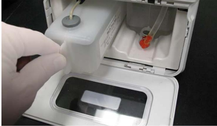
8. Depois que o recipiente estiver totalmente inserido, verifique a válvula na parte dianteira do recipiente de resíduos fluidos para se certificar de que está conectado firmemente e feche a porta do compartimento de fluidos.
