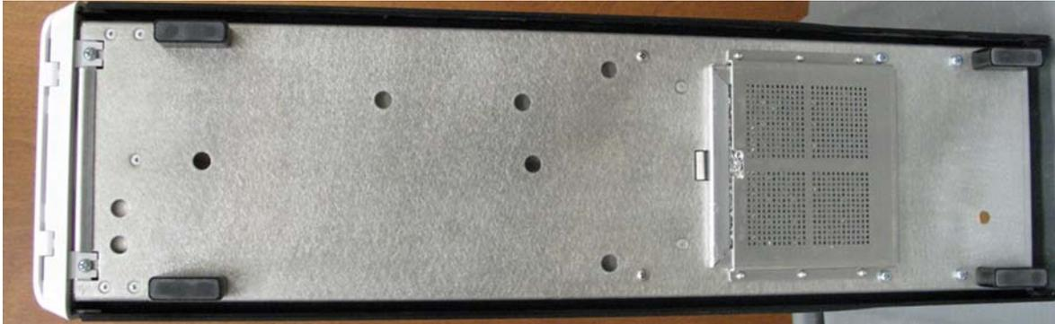
**FIGURA 49. Parte posterior do MAGPIX® mostrando o filtro colocado dentro do suporte**
