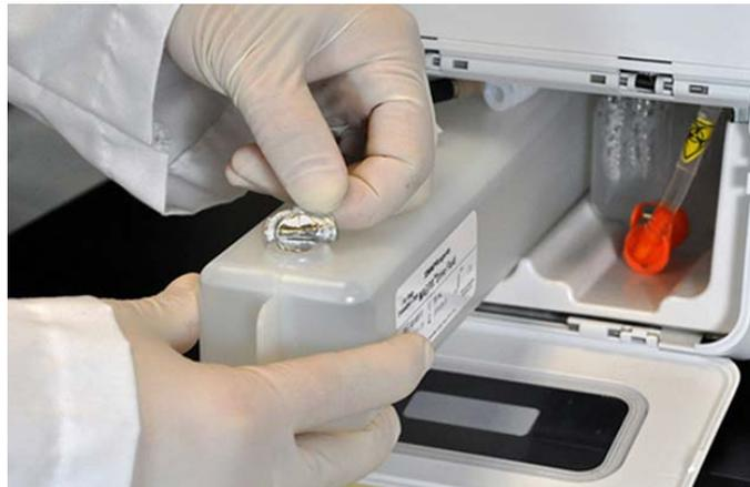
6. Conecte o tubo e o tampão do Drive Fluid (fluido de condução) à abertura na parte superior do recipiente do Drive Fluid (fluido de condução).
