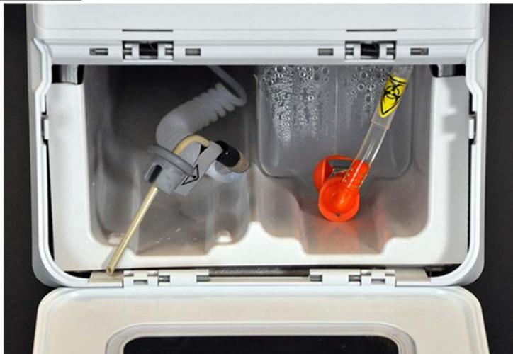
4. Puxe o tubo do Drive Fluid (fluido de condução) e o tampão (1) no lado esquerdo do compartimento de fluidos para a frente até que ele saia do compartimento. Puxe-o para a esquerda para abrir espaço para inserção do recipiente do Drive Fluid (fluido de condução).
