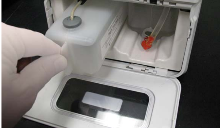
FIGURA 32. Deslizamiento del contenedor de líquido conductor
