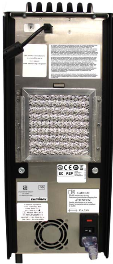
FIGURA 15. Cable de alimentación y cable USB conectados
