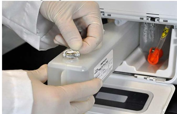
6. Verbinden Sie den Schlauch und den Stopfen für die Drive Fluid (Antriebsflüssigkeit) mit der Öffnung oben auf dem Drive Fluid-Behälter (Antriebsflüssigkeitsbehälter).
