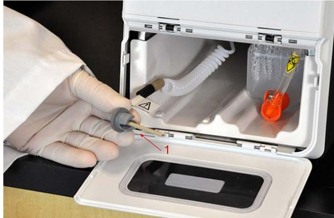
5. Schieben Sie den Drive Fluid-Behälter (Antriebsflüssigkeitsbehälter) zum Teil in das Flüssigkeitsfach und entfernen Sie die Versiegelung.
