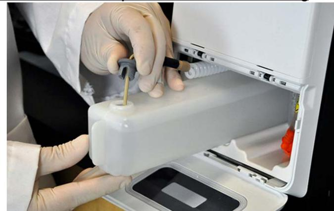
7. Schieben Sie den Behälter in die Ablage links im Flüssigkeitsfach. Die Behälterablage ist so geformt, dass der Behälter nicht verrutscht.
