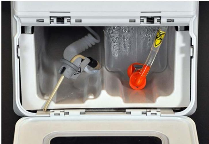
4. Ziehen Sie an dem für die Drive Fluid (Antriebsflüssigkeit) vorgesehenen Schlauch und Stopfen (1) links im Flüssigkeitsfach, bis sie aus dem Fach herausragen. Ziehen Sie sie nach links, um Platz zum Einsetzen des Drive Fluid-Behälters (Antriebsflüssigkeitsbehälters) zu machen.
