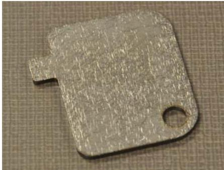
2. Stecken Sie das Werkzeug in die Verriegelung der seitlichen Zugangstür und drehen Sie es eine Vierteldrehung im Uhrzeigersinn.
