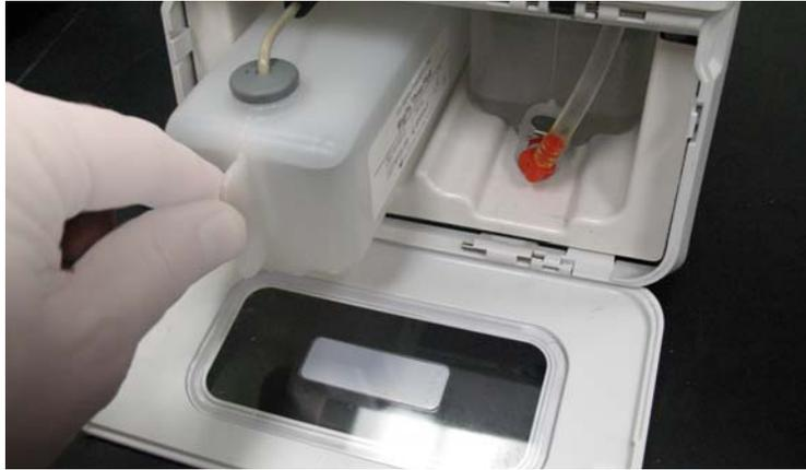
8. Nachdem Sie den Behälter vollständig eingeschoben haben, prüfen Sie das Ventil an der Vorderseite des Abwasserbehälters, um sicherzustellen, dass er sicher befestigt ist, und schließen Sie dann die Tür des Flüssigkeitsfachs.
