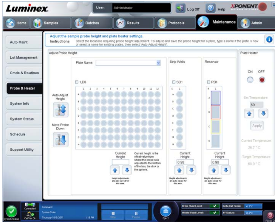
FIGURA 35. Regolazione dell'altezza della sonda di campionamento
