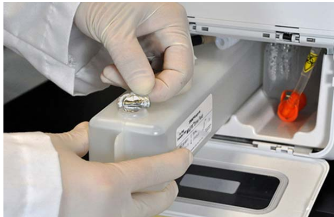
FIGURA 30. Rimozione del sigillo della lamina
