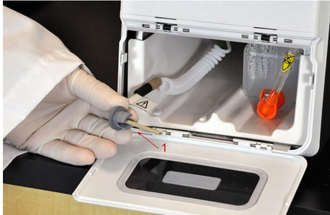
FIGURA 29. Estrazione del tubo del Drive Fluid (liquido di trascinamento) e della spina
