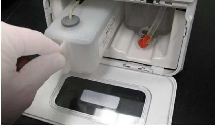
FIGURA 32. Inserimento del serbatoio del Drive Fluid (liquido di trascinamento)
