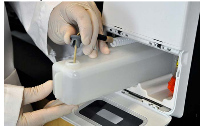
FIGURA 31. Inserimento del tubo e della spina nel foro del serbatoio
