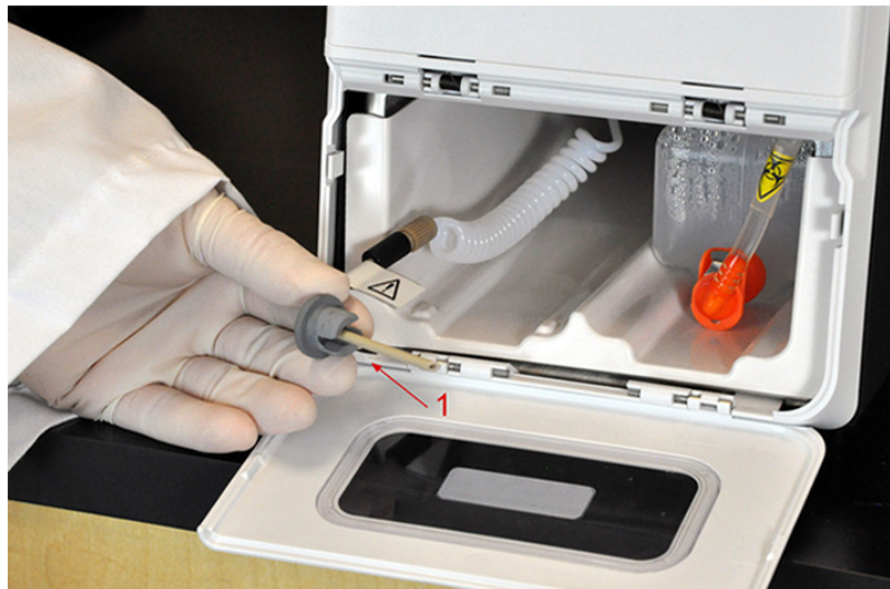
FIGUR 29. Udtrækning af drivvæskerør og stik
