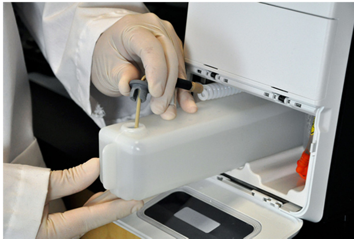
FIGUR 31. Tilslutning af rør og stik til beholderens åbning
