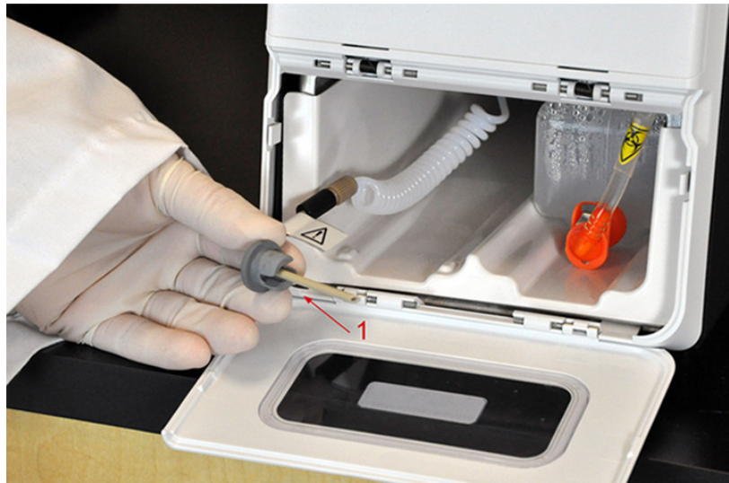
ABBILDUNG 29. Herausziehen des Antriebsflüssigkeitsschlauchs und -stopfens
