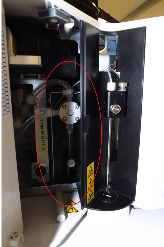
FIGURA 10. Vista frontal de un sistema Luminex® con la puerta abierta y la jeringa expuesta
